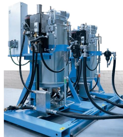
Die modulare Behälterstation mit TS5evo-Temperiergerät für konstante Rohstofftemperaturen selbst unter widrigsten Produktionsbedingungen.
