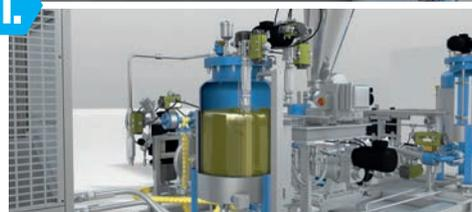
Die festen Stoffe in Pulverform sowie das Polyol werden für den Mischprozess vorbereitet und dann in die Mischkammer geleitet.
