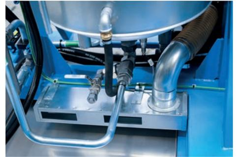
*Arbeitsbehälter mit optimaler Zugänglichkeit selbst bei optionaler Ausstattung mit Absaugung beim Einsatz brennbarer Rohstoffsysteme.*
