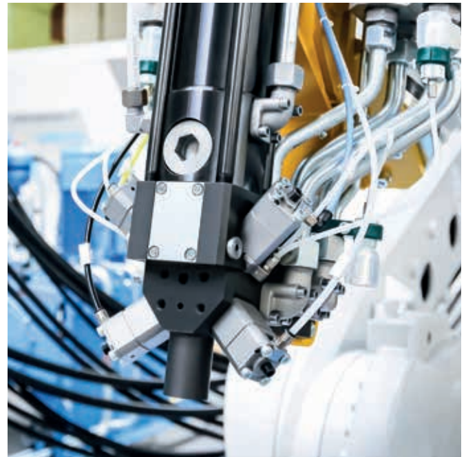
Perfekter Partner für vielfältige Anwendungen im Automotive-Bereich: Vier-Komponenten-Mischkopf mit hermetisch abgedichteten FLEXJET GL-Düsen.
