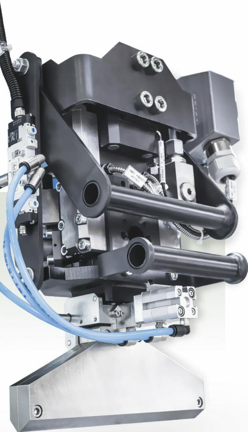
*Automatisierter Harzauftrag auf ein Fasergelege außerhalb der Presse: wartungsfreundlicher Breitschlitzverteiler für WCM-Anwendungen*
