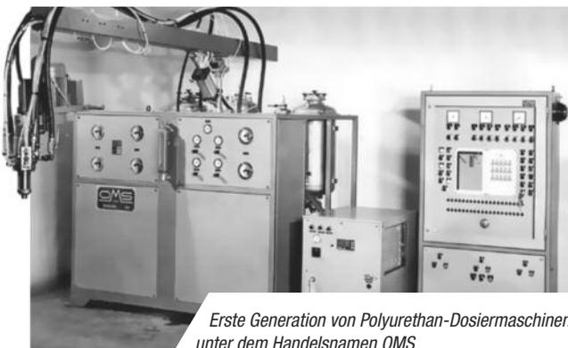
*Erste Generation von Polyurethan-Dosiermaschinen unter dem Handelsnamen OMS*
