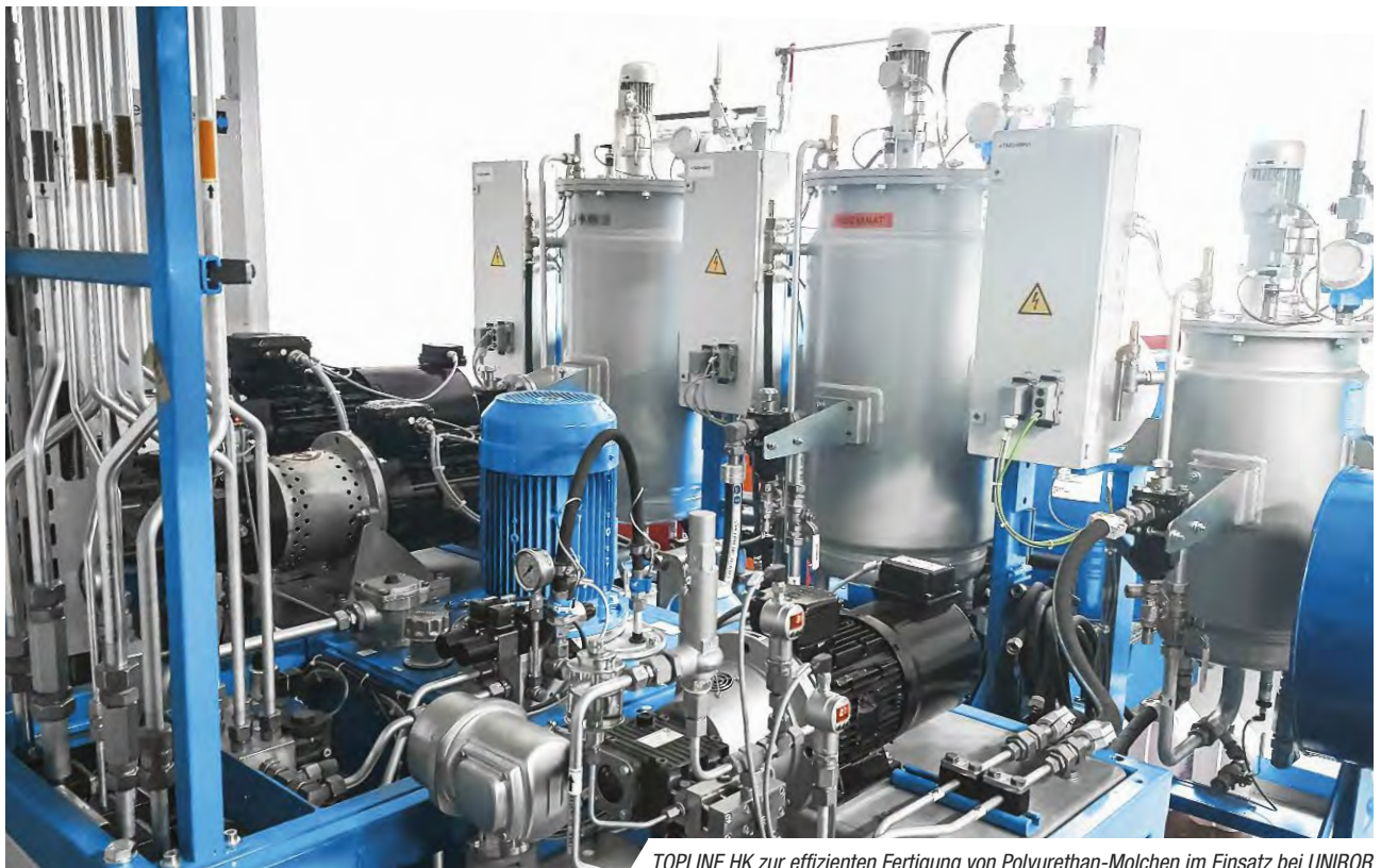
TOPLINE HK zur effizienten Fertigung von Polyurethan-Molchen im Einsatz bei UNIROR
