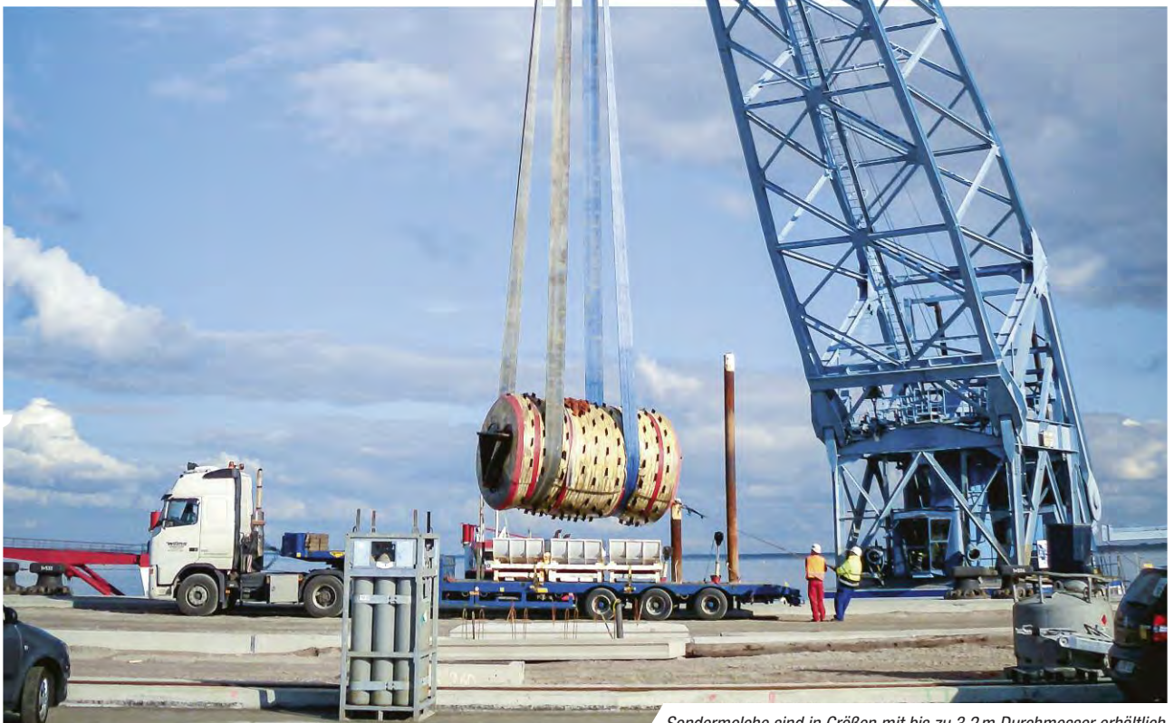
Sondermolche sind in Größen mit bis zu 3,2m Durchmesser erhältlich
