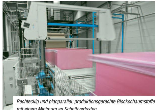
*Rechteckig und planparallel: produktionsgerechte Blockschaumstoffe mit einem Minimum an Schnittverlusten*
