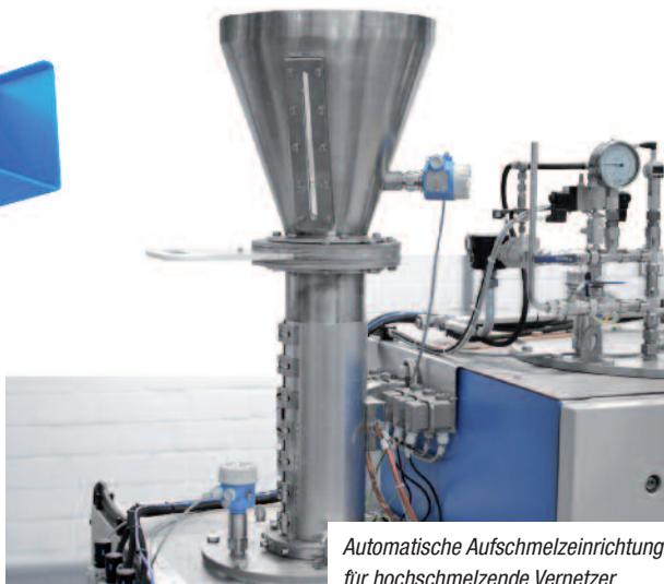
Automatische Aufschmelzeinrichtung für hochschmelzende Vernetzer
