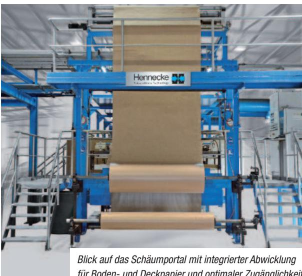
*Blick auf das Schäumportal mit integrierter Abwicklung für Boden- und Deckpapier und optimaler Zugänglichkeit*
