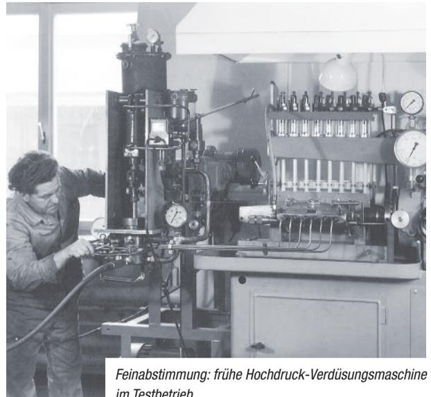
*Feinabstimmung: frühe Hochdruck-Verdüsungsmaschine im Testbetrieb*
