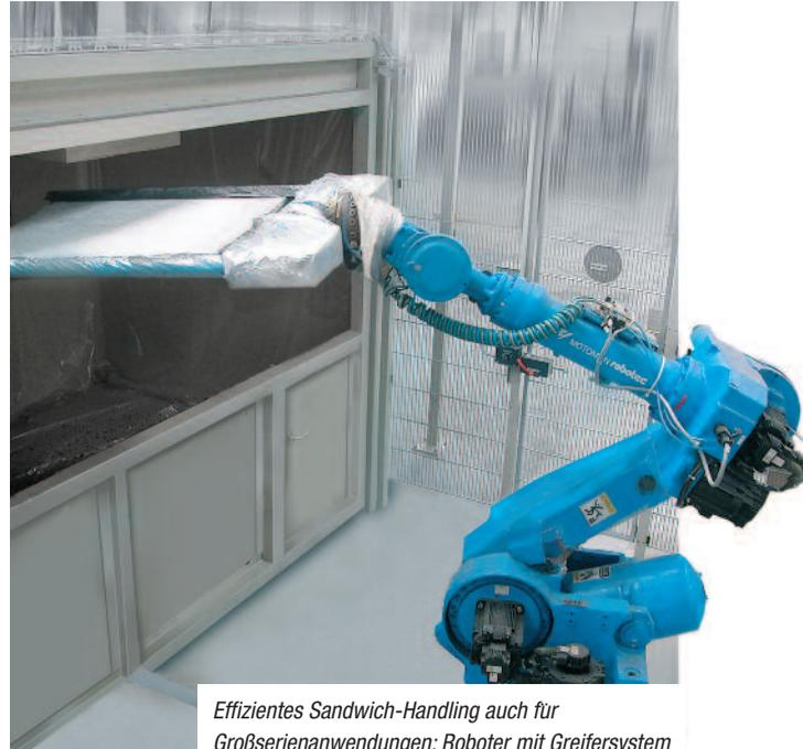
*Effizientes Sandwich-Handling auch für Großserienanwendungen: Roboter mit Greifersystem*
