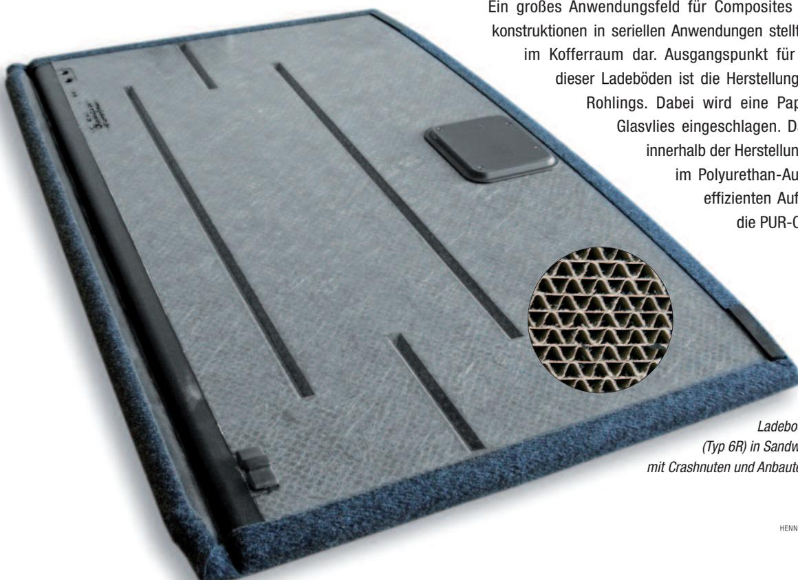
*Ladeboden des VW POLO (Typ 6R) in Sandwich-Bauweise mit Crashnuten und Anbauteilen*
