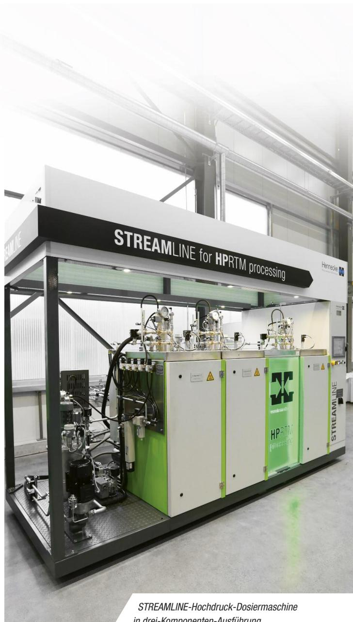
*STREAMLINE-Hochdruck-Dosiermaschine in drei-Komponenten-Ausführung*
