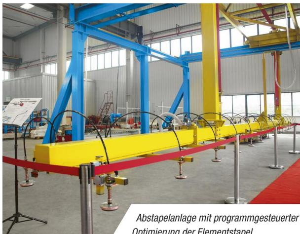
*Abstapelanlage mit programmgesteuerter Optimierung der Elementstapel*
