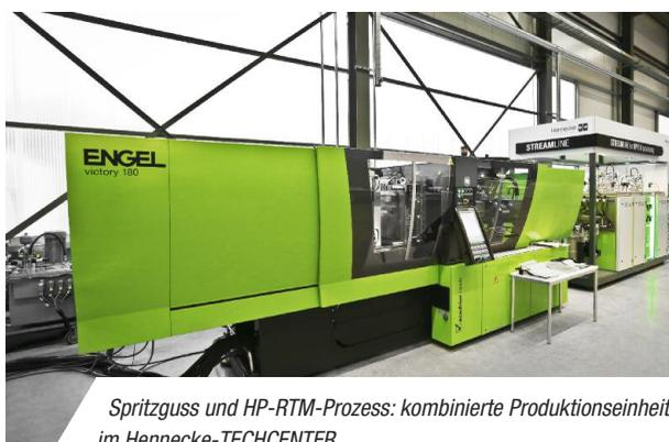
*Spritzguss und HP-RTM-Prozess: kombinierte Produktionseinheit im Hennecke-TECHCENTER*
